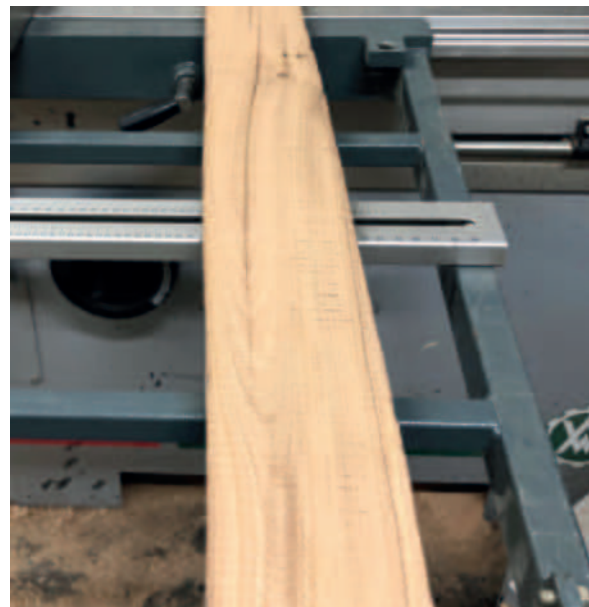
Récupération de poutres rue Godefroy-Cavaignac, à Paris (ci-dessus). Réusiné, ce bois très marqué reprend un bel aspect (ci-contre).
