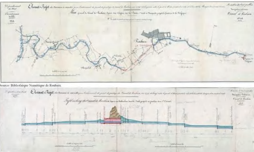
Vue en plan et en coupe du projet de canal abandonné reliant La Deûle à Roubaix
